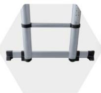
Construite avec des profils en aluminium anodisé. Échelons de 40 mm. d'empreinte avec reliefs antidérapants. Distance entre les échelons de 300 mm. Base stabilisatrice avec patins en PVC antidérapants. Système de verrouillage automatique, l'échelle se rabat progressivement au moment du déverrouillage. Il peut être utilisé à des hauteurs de travail variables. Conçues pour supporter 150 kg. selon la Norme EN 131-6.
